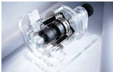
Auf der Bohrplattform PRA-1, vor Brasilien, kommen 18 Stück Magnetkupplungen **MAKH66-110-3/43-00** zum Einsatz. Sie dichten eine Kreiselpumpe von Sulzer (ZF 25-200) in einem Sperrdrucksystem bei 90 bar zur Versorgung der GLRD einer Rohölpumpe ab. Seit 2005 beweisen die Magnetkupplungen ihre Wartungsarmut an einem schwer zugänglichen Ort. Medium: Sperrflüssigkeit ISO Vg 46; Betriebsbedingungen: p = 90 bar (1.305 PSI); t = 70 °C (158 °F); n = 3.500 min<sup>-1</sup>.
