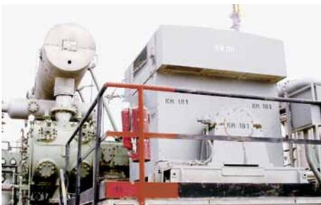
In Kompressoren bei Saudi Aramco in Saudi Arabien ist eine **PDGS2/130-ZT3-U** im Einsatz. Betriebsbedingungen: p ... 50 bar (725 PSI); t = -20 °C ... 177 °C (-4 °F ... 351 °F); n = 15.800 min<sup>-1</sup>.
