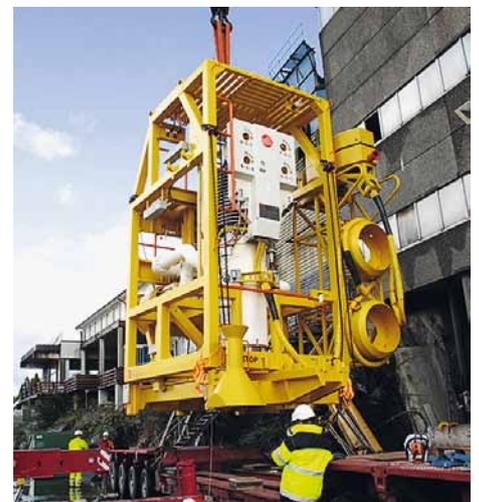
Subsea Multiphasenpumpe abgedichtet mit Gleitringdichtungen vom Typ EagleBurgmann **SH18/115**. Betriebsbedingungen: Medium: Öl-Wasser-Gas-Gemisch; Gasanteil: 25 ... 70 %; Saugdruck:  $p = 5 \dots 70 \text{ bar}$  (73 ... 1.015 PSI); Rotationsgeschwindigkeit:  $n = 4.200 \text{ min}^{-1}$ .
