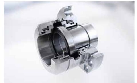
In einem Hochdruck-Multiphasentestkreislauf von Statoil in Norwegen ist eine Bornemann MPC mit einer EagleBurgmann **SHFVI-D2/88-E1** Doppeldichtung und einem Versorgungssystem nach API 53B ausgerüstet. Trotz extrem schwankender Druckbedingungen läuft die Dichtung seit Inbetriebnahme ohne Probleme. Betriebsbedingungen: Druck im Dichtungsraum: p<sub>1</sub> = 10 ... 150 bar (145 ... 2.175 PSI); Sperrdruck: p<sub>3</sub> = 160 bar (2.320 PSI); t = 60 °C (140 °F); n = 1.800 min<sup>-1</sup>.
