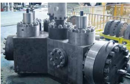
Ein Hersteller von Bohrequipment setzt in seinen Wellheads speziell für Hochdruck ausgelegte EagleBurgmann **Ring Type Joints** vom Typ RX ein. Medium: Bohrschlämme, Wasser/Sandgemenge, Sauer gas, Erdgas, schwere Schwefelwasserstoffe. Die RTJs sind auch bei den extremen Einsatzbedingungen zuverlässig dicht. Betriebsbedingungen: p ... 1.370 bar (19.870 PSI); t ... 60 °C (140 °F).
