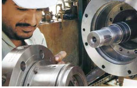
Bei Saudi Aramco, Saudi-Arabien, ist in einer Helikoaxial Multiphasenpumpe von Sulzer eine **SHV-D2/145-E1** von EagleBurgmann als Doppeldichtung im Einsatz. Betriebsbedingungen: Gasanteil ... 99 %; p = 60 bar (870 PSI); t = 80 °C (176 °F); n = 4.000 min<sup>-1</sup>.
