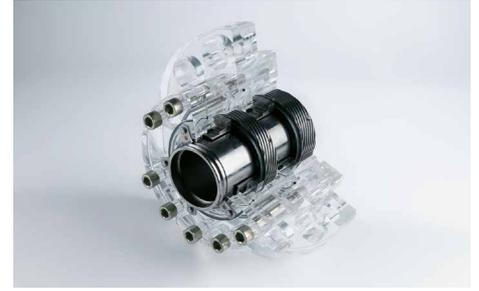
Im Kernkraftwerk Olkiluoto (Block 3) in Finnland muss radioaktiv kontaminiertes Reaktorwasser in einer CVCS Hochdruckförderpumpe absolut zuverlässig gefördert werden. Zur Abdichtung wird eine Gleitringdichtung **SHFV-D4-/77-E1-Q** verwendet. Betriebsbedingungen:  $p = 181 \text{ bar (2.625 PSI)}$ ;  $t = 15 \dots 100 \text{ °C (59 \dots 212 °F)}$ ;  $n = 2.980 \text{ min}^{-1}$ .
