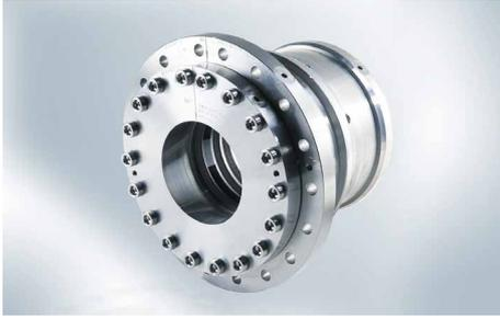
Für eine Sperrarmatur zur Schließung von Klappen im Notfall wird im Kernkraftwerk Olkiluoto (Block 3), Finnland, zur Abdichtung des Dampfes eine Kohleschwimmringdichtung vom Typ **Espey® WKA600S** mit Leckageabführung verwendet. Betriebsbedingungen:  $p = 11,6 \text{ bar (168 PSI)}$ ;  $t = 311 \text{ °C (592 °F)}$ .
