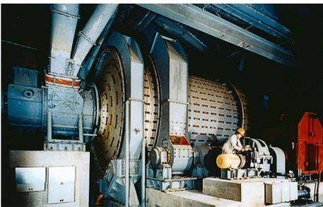
In einem Kraftwerk der Dezhou Shandong Huaneng Power Development Co. Ltd. in China muss im Mühlenhals einer Kohlemühle kohlestaubhaltige, heiße Abluft zuverlässig durch eine Sperrluft abgedichtet werden. Die optimale Lösung: eine **Espey® WD200/500**. Betriebsbedingungen:  $p = 1,08 \text{ bar}$  (15,66 PSI);  $t = 110 \text{ °C}$  (230 °F);  $n = 15,8 \text{ min}^{-1}$ .
