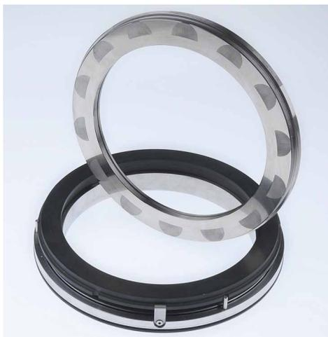
EagleBurgmann MDGS sind robuste Dichtungen für Schraubenkompressoren. Sie zeichnen sich durch den aus duktilem Material bestehenden rotierenden Ring mit einer Hochleistungsbeschichtung aus. Dieser ist "In-situ-shrouded", und ist daher praktisch unzerstörbar. Die Beschichtung bietet eine herausragende Verschleißfestigkeit im Niedrig-Drehzahlbereich (z. B. Abfahren oder Turning-Betrieb) bei dem ein Berühren der Gleitflächen unvermeidbar ist.
