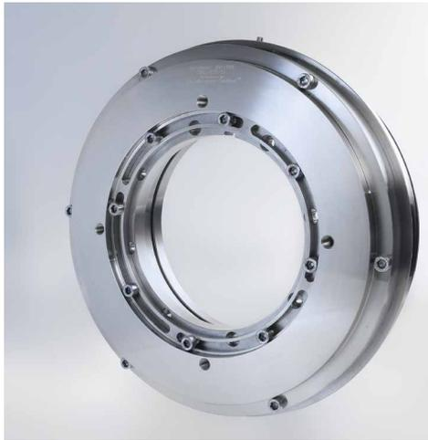
Seit Markteinführung hat sich die innovative Dichtungslösung in Erstausrüstung und Nachrüstung weltweit bewährt. Sie besteht aus einem rotierenden Gegenring aus duktilem Material und einer stationären, federbelasteten Dichtfläche. Das Trenngas wird durch Axialbohrungen durch die stationäre Dichtfläche in die Mitte der Gleitfläche geleitet und im Dichtspalt in zwei Leckströme geteilt, die zum Innen- und Außendurchmesser der Gleitfläche führen.
