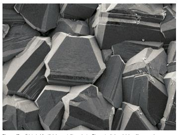
DiamondFace® ist ein künstlich hergestellter, reinster Diamant mit den gleichen überragenden Eigenschaften wie Naturdiamant. Er wird als mikrokristalline Beschichtung auf Siliziumkarbid-Gleitringe aufgebracht.
