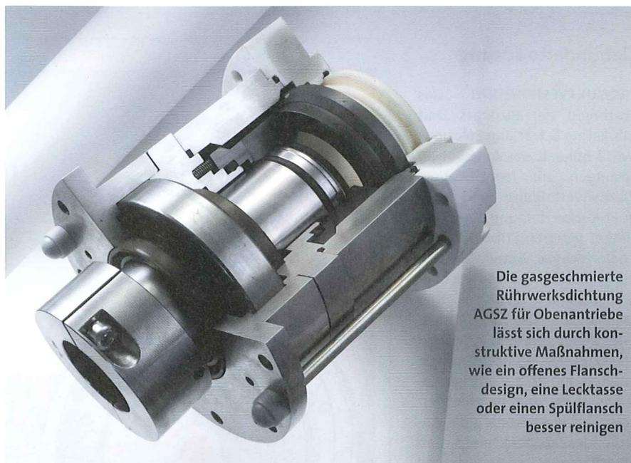
Die gasgeschmierte Rührwerksdichtung AGSZ für Obenantriebe lässt sich durch konstruktive Maßnahmen, wie ein offenes Flanschdesign, eine Lecktasche oder einen Spülflansch besser reinigen
