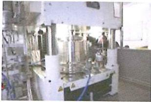
Auf den Prüfständen von EggleBurgmann lassen sich Dichtungen bis ca. 800 mm festem und die Prozessbedingungen simulieren.
