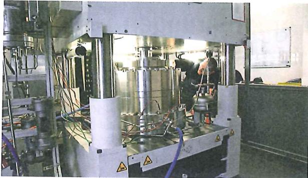
>>2: Auf den eigenen Prüfständen können Dichtungen bis ca. 800 mm getestet und die Prozessbedingungen simuliert werden
